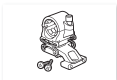
麦克风卡座 (随附 M4 固定螺栓, x2)
